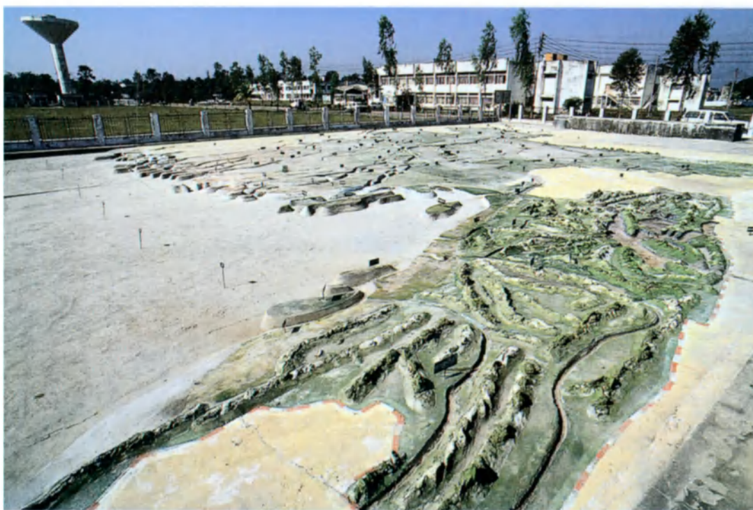
Bassin de simulation du Centre de recherche de Faridpur (Bangladesh) où l'on étudie la circulation des eaux en cas d'inondation en vue de la construction de digues.
